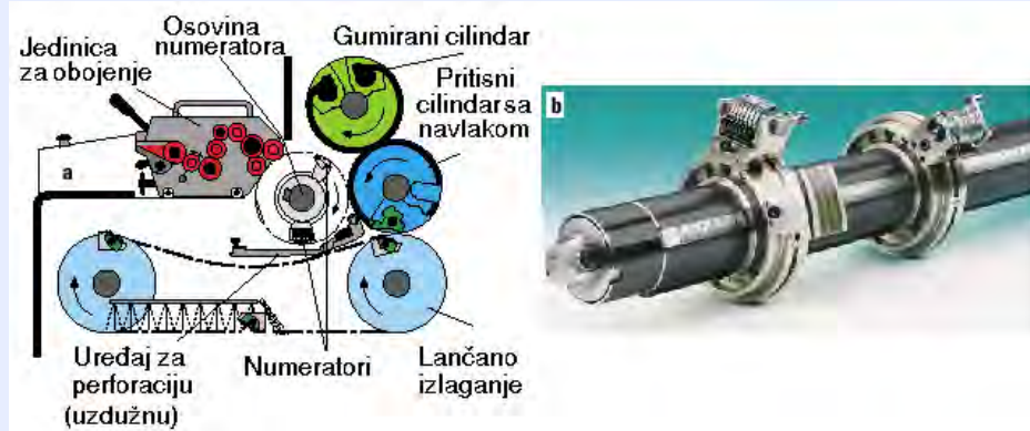
Numeratori a) jednobojna mašina, b) numerator sa uzdužnim i poprečnim elementom
