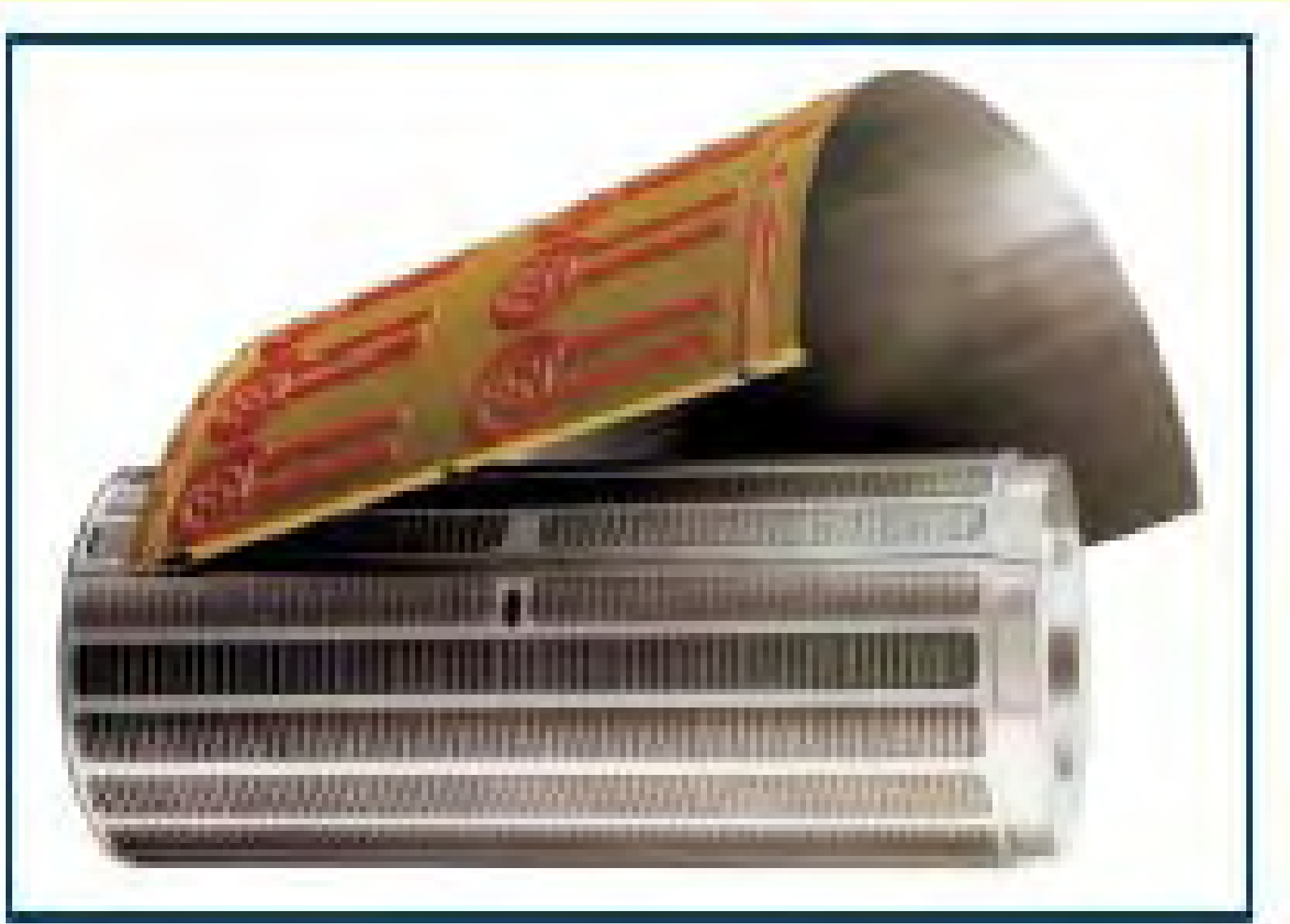
Magnetni cilindar sa pločom visoke štampe (NELA)
