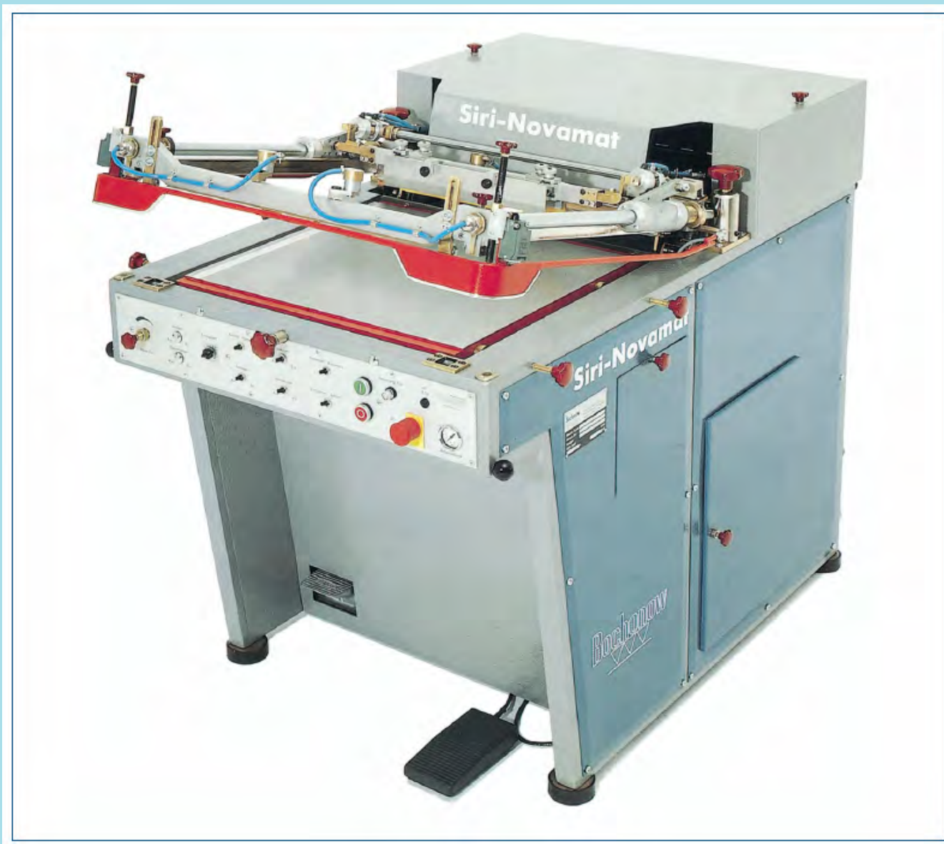
Poluatomatski sto sito štampe za oštampavanje ravnih podloga. Ulaganje i izlaganje tabaka vrši se ručno na vakuumskom stolu.
