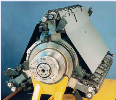
Trocilindrični sistem sa dvostruko većim cilindrom za pritisak i trostruko većim prenosnom dobošem (Heidelberg)
