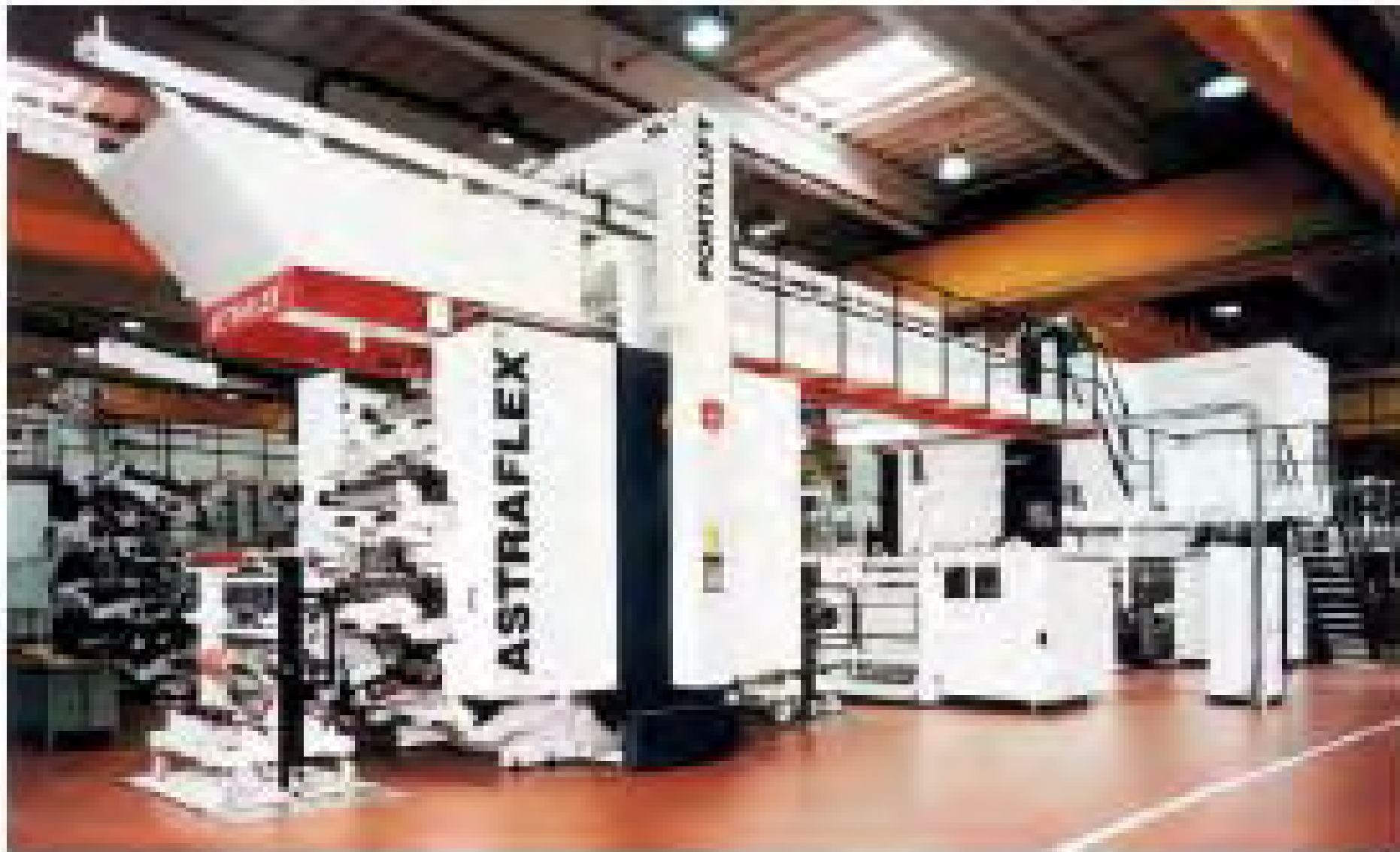
Centralnocilindarska fleksoštamparska mašina sa 8 štamparskih jedinica i visokim stepenom automatizacije (Astraflex W&H )
